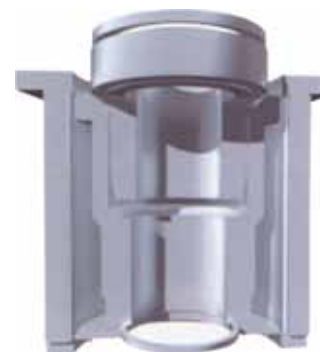
插入式自调安装方便快捷，补偿式联轴结构消除偏心矩
